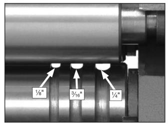
Figure 28. Wire grooves.
